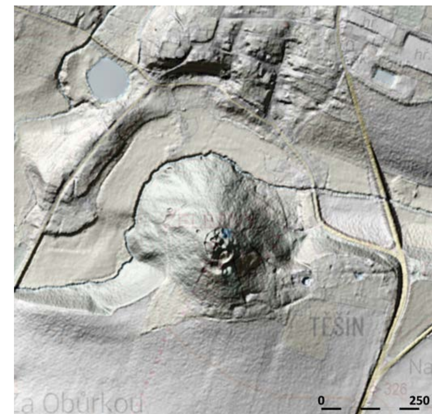
Hrádek Železný na datech z leteckého laserového skenování (zdroj: ČUZK). Odfiltrováním lesního porostu je ze snímku patrná dispozice hradu tvořená valem a příkopem a zároveň je zřetelné i jeho poškození pozdějším lámáním kamene.
